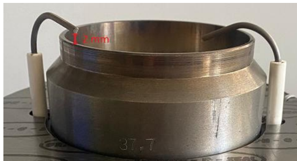
Abbildung 10: Ausrichtung Zündelektrode
